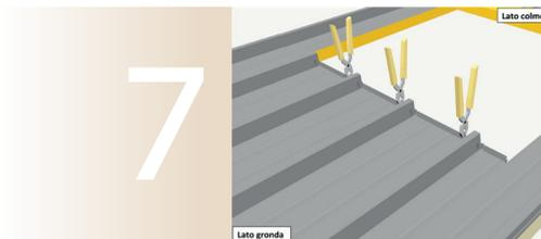
Sul foro rettangolare lato gronda, per evitare la risalita dell'acqua, sollevare il lembo della lamiera con una pinza piega lamiera.
