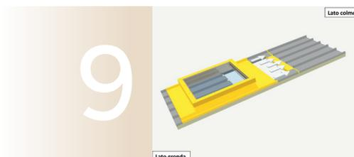
Poggiare il lucernario sul pannello. Spingerlo con forza verso l'alto e inserirlo al di sotto della lamiera incisa con il "taglio A" effettuato nel passo 5.
