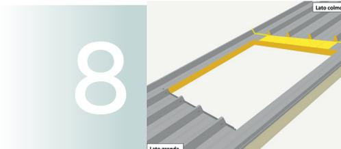
Se i seguenti passaggi sono stati eseguiti correttamente, il pannello prima del montaggio del lucernario si presenterà nel seguente modo.
