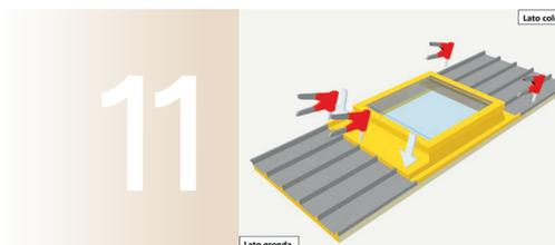
Una volta ben inserito il lucernario sul pannello procedere con la foratura e a questo punto si può passare al fissaggio.
